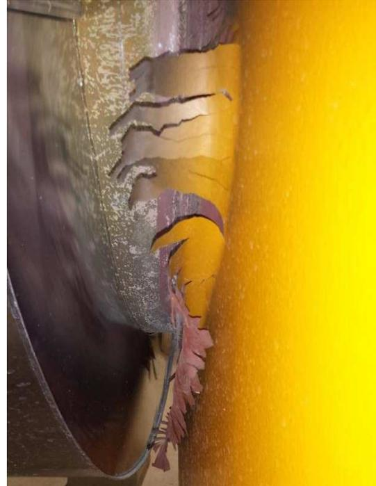
La remise en chauffe a été stoppée pour permettre des investigations à l'intérieur de la boîte à vent et de la canalisation d'air. Dans la boîte à vent, le joint au niveau de la connexion avec la conduite d'air, a été renforcé et à l'extérieur des piquages d'injection d'air de refroidissement ont été ajoutés.
