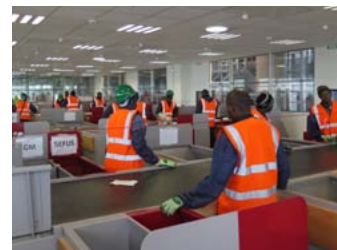
Les agents affinent le tri en retirant des flux les objets qui n'ont pas suivi le bon circuit.
